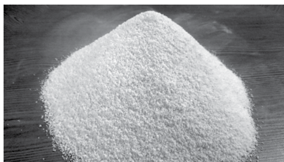
▲ شکل ۵ گچ ساختمان
